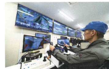
中央操作室からの重機遠隔操作
