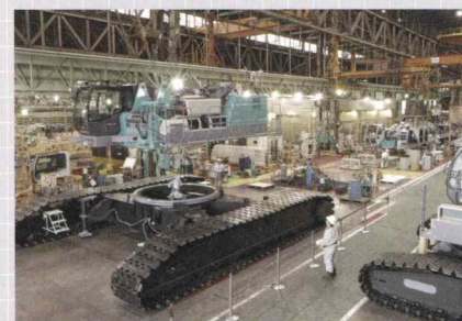
クローラークレーン組立ライン(大久保工場)
