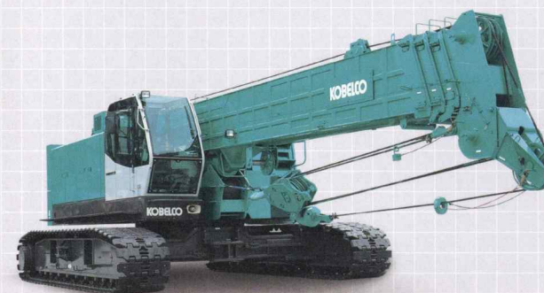
テレスコピッククローラクレーン クローラ式の安定性とブーム伸縮の作業性が両立。
