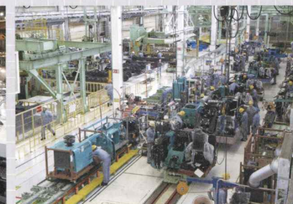
油圧ショベル組立ライン(五日市工場)
