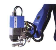
ロボット加工ユニット
