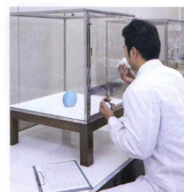
ガラス箱法によるカトリスの殺虫試験
