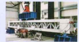
複合トラス梁載荷試験
