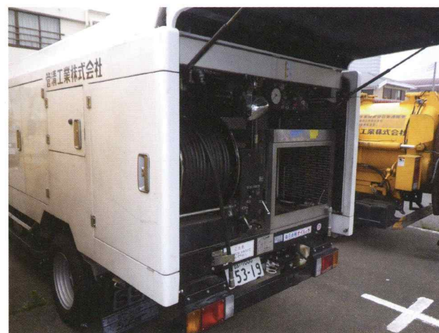
高圧洗浄車 高圧洗浄機を搭載し、管径に合わせたノズルをホース先端に取り付け管内を洗浄します。
