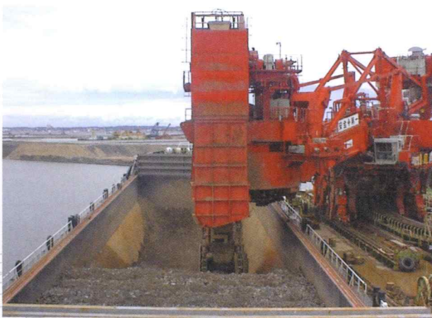
3,000m 3 /hチェーンバケット式リクレマ船
