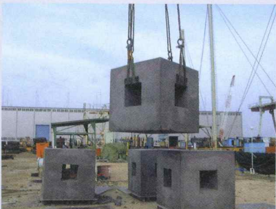
石灰灰リサイクル漁礁製作実験
