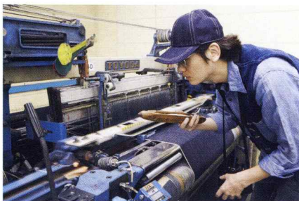
↑名機として知られる豊田自動織機製のシャトル織機。使い込まれたシャトルがタテ糸の間を高速で往復移動して生地を織り上げる
