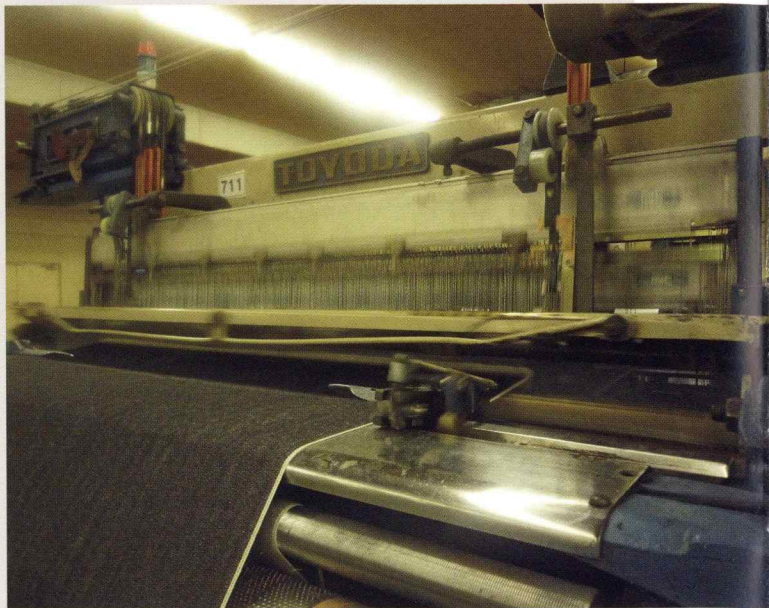
↑豊田自動織機の創業者であり、織機王と呼ばれた豊田佐吉が作った伝説の名機type G1は画期的な無停止稼働式自動織機として登場した。シャトル(杆)交換を自動で行う機構など、革新的技術が惜しみなく投入され、生産性はそれまでの織機の20倍に達したという。その遺伝子を引き継いだ名機がこのtype G9である。カイハラ工場にはいまでも現役のG9が並び、大きな音を立ててヴィンテージ生地を織り上げている。渾身のヴィンテージ生地カイハラNo.5もここで生まれる
