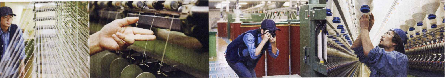
ウハウでブレンドされた原綿が紡績工程へ回される。リング紡績とオープンエンド紡績を使い分け、求める糸質に仕上げる。粗紡機でできた粗糸は、さらに細くかけられ、5〜20番手の一定の太さの糸に紡がれる。紡績された糸は染色工程でムラなく染めるため、600〜900本、約6000ヤードの長さの糸束に束ねられる(左端写真)。整経と呼ばれるこの工程はカイハラが独自開発した機械で行われる。無数の糸が1つに纏まる様子は美しいの一言
