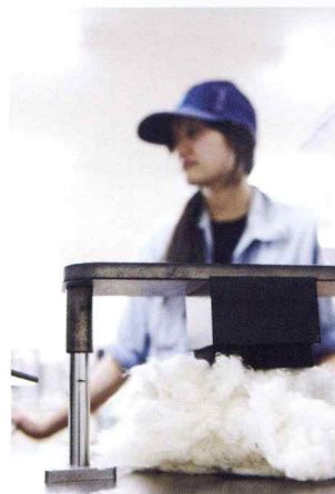
↑原綿は混ざり物を取り除いた後、繊維の向きを揃えられ、太いヒモ状の「スライバー」に加工される。この状態を経て紡績の工程へと回される。「スライバーを1本だけ持たないか? これを使って何か作れるかも」。井浦が手に入れたスライバー、その後、何に形を変えたのだろうか?
