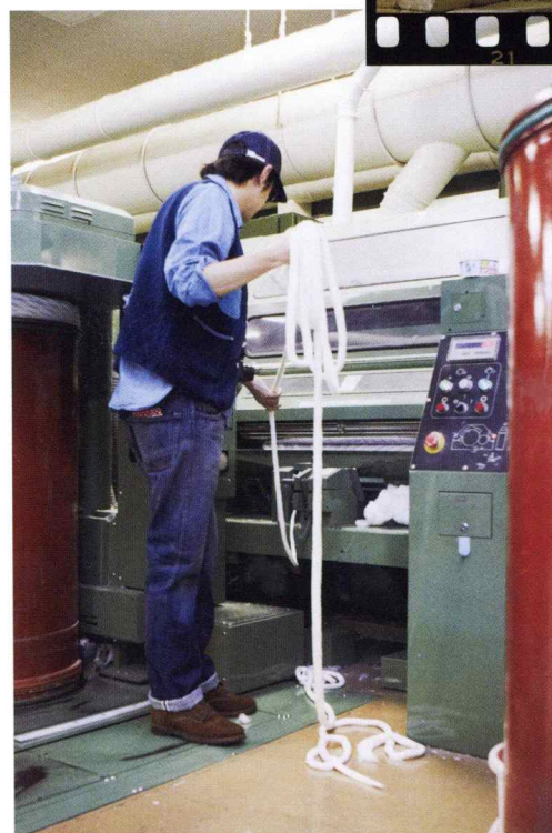
↑原綿は混ざり物を取り除いた後、繊維の向きを揃えられ、太いヒモ状の「スライバー」に加工される。この状態を経て紡績の工程へと回される。「スライバーを1本だけ持たないか? これを使って何か作れるかも」。井浦が手に入れたスライバー、その後、何に形を変えたのだろうか?
