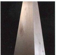
独自の開発により、檜の持つ美しさを損なわない「無背割れ材」を、主要な柱部分に使用しております。強度が高く腐食や虫害に強い檜材だから、末永く安心してお住まいいただけます。
