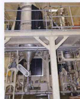
「粉体貯蔵槽における静電気危険性の研究」に使用する実規模実験装置
