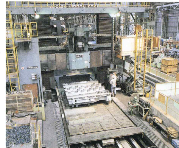
5面加工機 (テーブルの大きさ) × 切削巾 × 切削高さ (3.5m×10m) × 4m × 3.8m
