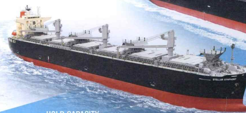
HOLD CAPACITY 3,600,000 C.F. TYPE WOODCHIP CARRIER (L) 199.96× (B) 32.24× (D) 22.9
