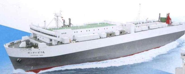
12,400 GT TYPE ROLL ON/ROLL OFF CARGO SHIP (L) 179.94× (B) 27.6× (D) 22.4
