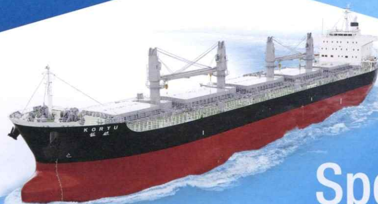
53,000 M.T. D/W TYPE COPPER ORE & SULPHURIC ACID CARRIER (L) 189.95× (B) 32.26× (D) 17.9
