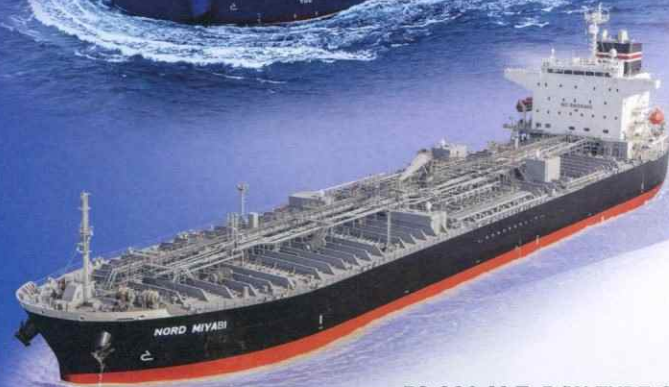
52,000 M.T. D/W TYPE CHEMICAL/PRODUCT OIL TANKER (L) 184.94× (B) 32.2× (D) 19.1
