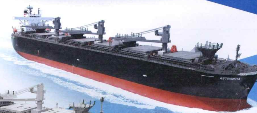
HOLD CAPACITY 4,300,000 C.F. TYPE WOODCHIP CARRIER (L) 209.94× (B) 36.0× (D) 23.5
