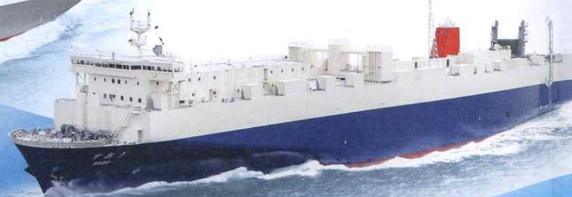
11,700 GT TYPE ROLL ON/ROLL OFF CARGO SHIP (L) 179.90× (B) 27.0× (D) 23.27
