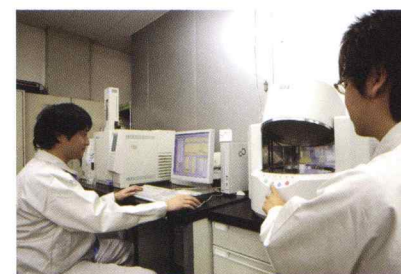
ガスクロマトグラフ質量分析計(GCMS) + エネルギー分散型蛍光 X線分析装置(EDX) Gas chromatograph mass spectrometer (GCMS), Energy dispersive X-ray fluorescence spectrometer (EDX)
