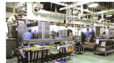
業務用冷凍冷蔵庫セル生産方式 Cell production method for refrigerators
