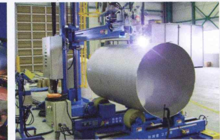
自動溶接機 Automatic welding machine
