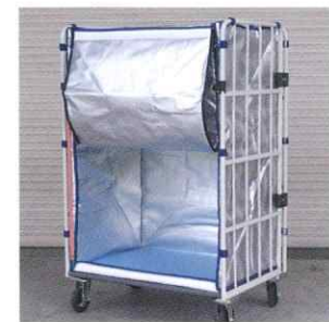
かご車(キーパー&コンテナ) アルミ箔ラミネートフィルムと高発泡 ポリエチレンシート(又は、ビーズ発 泡ボード)を積層した原反を複合縫 製しており、アルミ箔の光・熱の反 射効果、発泡体の断熱性によって、 優れた遮光・断熱性を発揮します。
