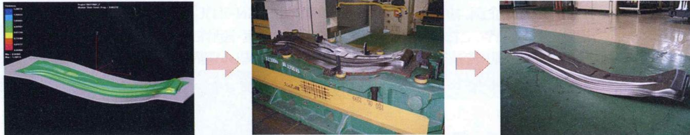
成形シミュレーションによる加工性・生産性評価に基づいて最適な工程設定、金型構想を立案し、金型設計・製作へ反映させております。
