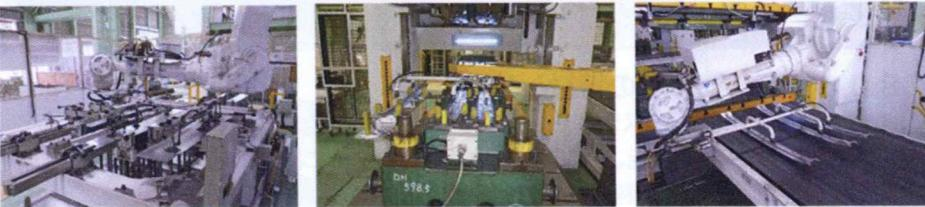
タンデムプレスラインに複数の材料を投入します。→ 最終工程より同時に3つの製品が出てきます。
