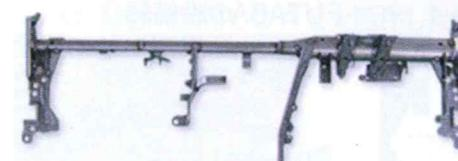
ハンドル等を支持するフレームでインストルメントパネル内にあります。マツダ・日産・ダイハツの車両に採用されています。本製品はハンドルの振動制御性能、乗員安全性を確保しながら同時に軽量化を求めています。そのため、振動解析、強度解析が必要で開発要素が多いため構想段階よりカーメーカーと共同開発を行なっています。
