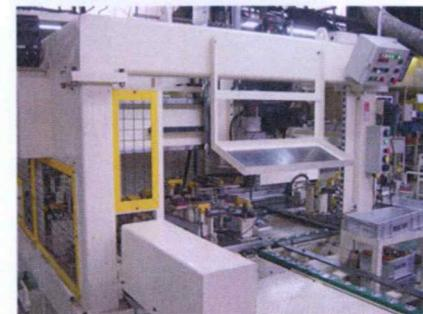
ロードスター RHT (リトラクタブルハードトップ) のハードトップ可動部のアッセンブリーを行うため、カシメ装置を導入しました。また、このカシメ装置を自動化することにより省人・省力化を実現しています。
