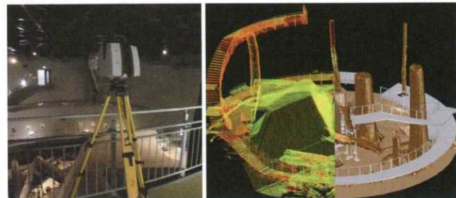
計測の様子 三次元点群データと三次元モデル表示
