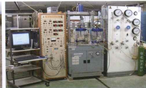
振動(動的・液状化)三軸圧縮試験 自社試験室での土質試験による評価
