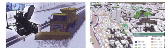
除雪車両運転教育用「車両操作シミュレータ」 NEXCO中日本と共同開発
