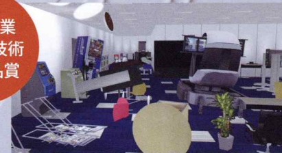
「UC-win/Road 地震シミュレータ」 揺れをVRで表現し、建物内部の什器や家具への影響をシミュレート
