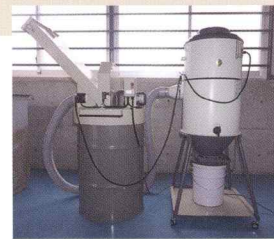
蛍光管破碎施設の概要 ●処理能力：4 t /日 ●稼働時間：8時間稼働 ●処理品目：廃蛍光管
