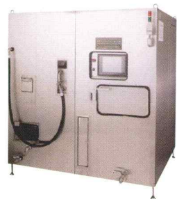
メチルエステル化燃料再生施設の概要 ●処理能力：400ℓ /日 ●処理品目：植物性油
