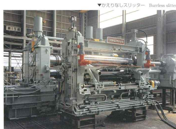
▼かえりなしリッター Burrless slitter
