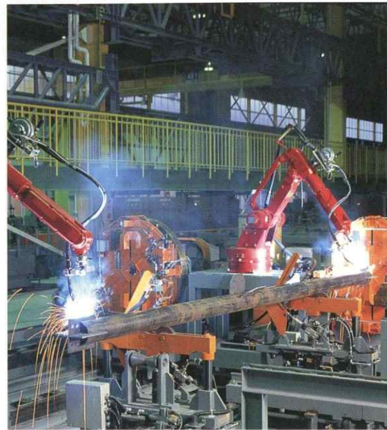
▲鋼管ロボット溶接装置 Pipe welding robot
