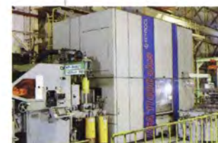
ファイブランキング加工により複雑な高精度部品をローコストで生産。
