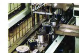
画像検知による検査工程を持つリクライナー自動組立ライン。
