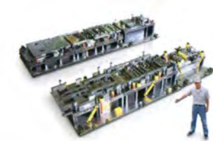
1ストロークごとのプレス工程を考慮し設計した順送金型も内製化。
