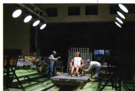
スレッド試験機により実際のシートを実証実験し安全性を確認しています。
