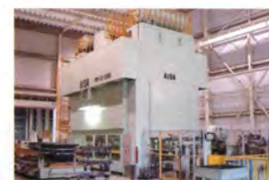
1200tプレス機トランスファー加工で大型の三次元形状部品を製造。
