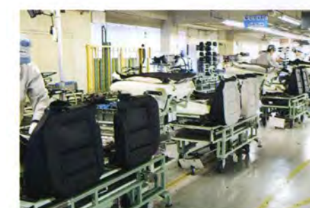
IDの管理とAGV生産方式により仕様の異なる同期混流生産が可能です。
