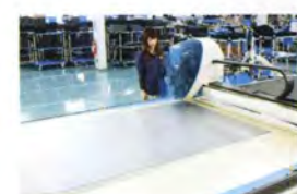
型入システムによるデータで表皮材をムダ無く自動裁断。
