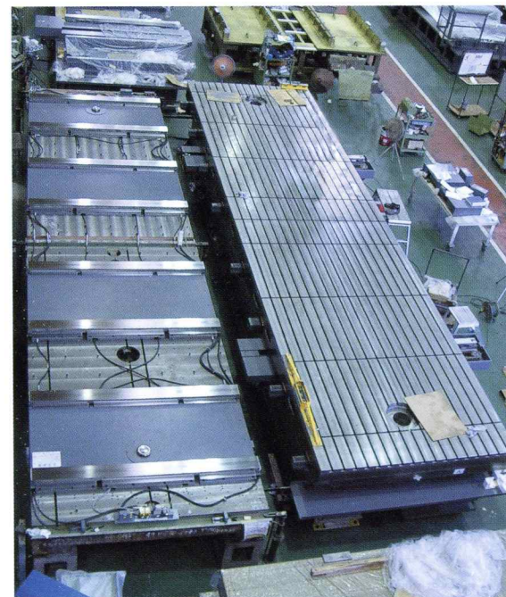
APC (オートパレットチェンジャー) パレットサイズ: 9700 L × 2500 W
