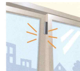
防犯センサー 防犯モード中にセンサー設置の玄関扉・窓などが開けられると、警備会社に警報信号が発信されます。
