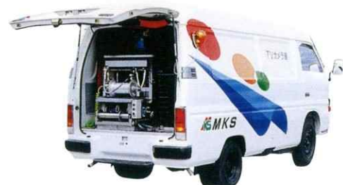
正面画像と側面画像が交互に切り換えられ、カメラヘッドが360°回転することにより、管内すべてが調査でき、不良箇所等は写真撮影及び、ビデオ撮影により、鮮明に現状を把握できます。
