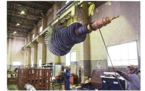
タービンローター運搬作業
