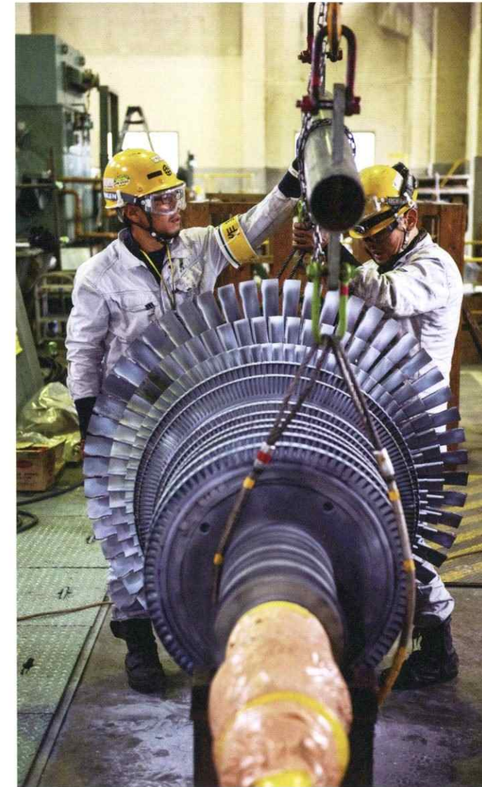
タービンローター玉掛け作業
