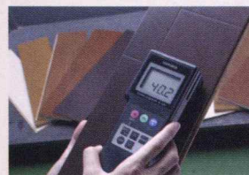
フローリング材の塗膜検査
