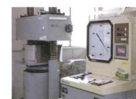
コンクリートの圧縮強度試験
