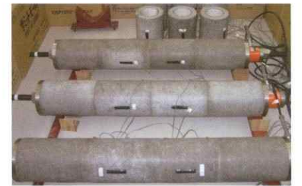
再生骨材を有効利用したコンクリートポールの開発研究状況(クリープ及び乾燥収縮試験状況)
