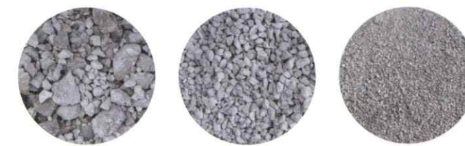
再生路盤材(RC-40) 再生碎石(5~15mm) 再生砕砂(5mm以下)
