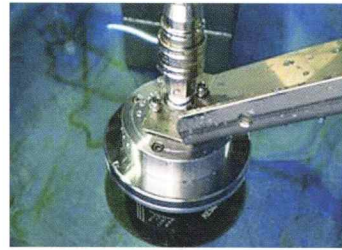
水圧を利用した遠隔研磨システム
