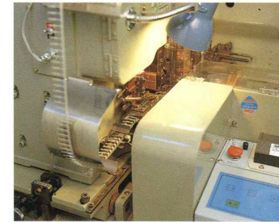
圧着不良を自動的に検知するセンサー
