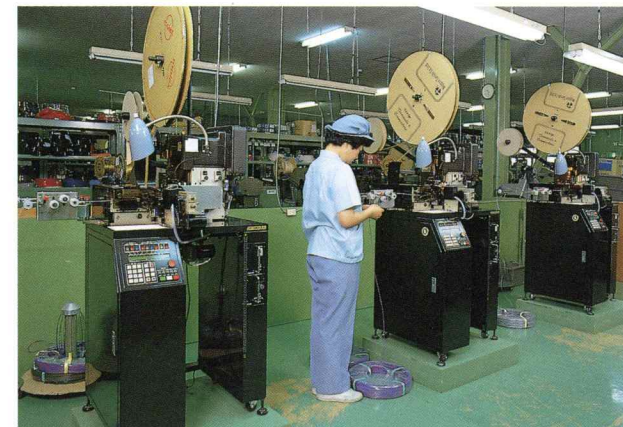
多能工による全自動切断圧着工程
