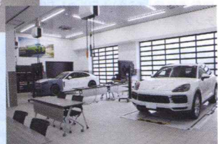
1つのトレーニングルームに3ベイをあて、特注ダブルパスカルとフラットアームタイプの特注ネオバスカルを各1基設備
