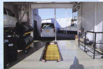
オイル交換専用のオイルピットも設備
