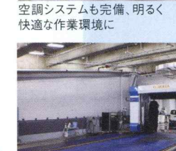
門型洗車機「エミネントデルタ」、FRPグレティングで水はね、滑りを防止
