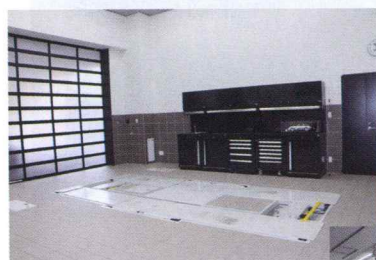
センター正面側の準備室。ドライブオン&フリーホイール対応のダブルパスカル、前後にピットジャッキを装備
